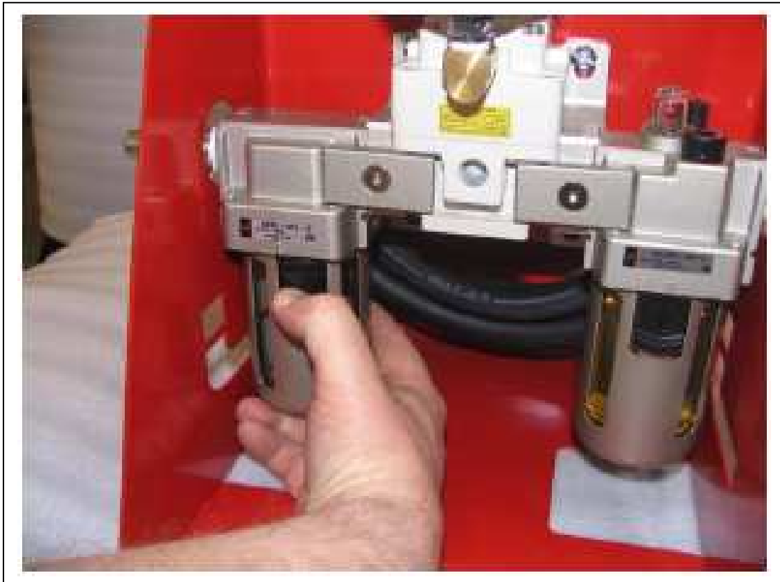
Figura 14. Esvaziando o Reservatório do Filtro da FRL
