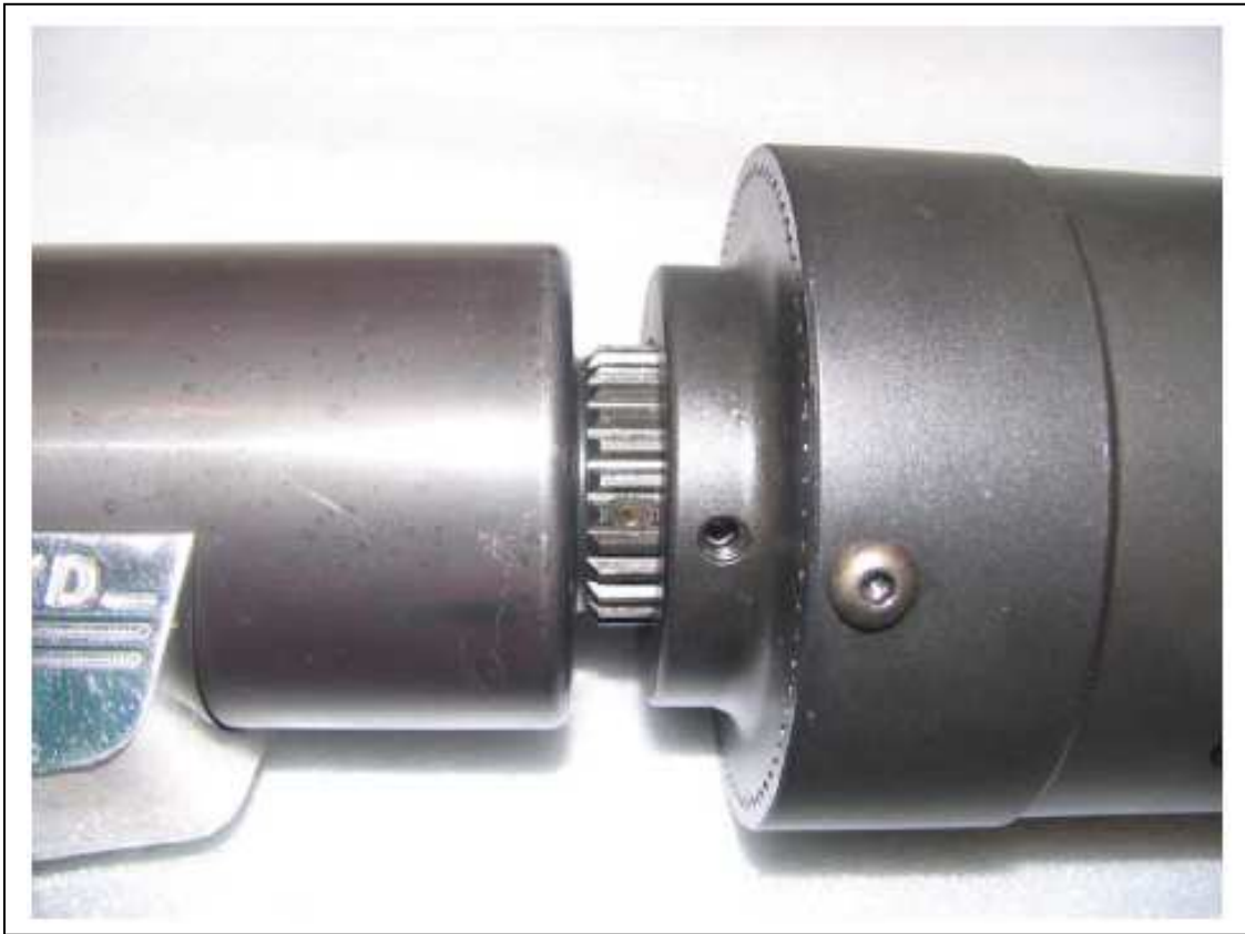
Figura 22. Alinhando o Parafuso de Fixação do Soquete LoaDisc com o Recesso Mecânico nas ranhuras da jGun
