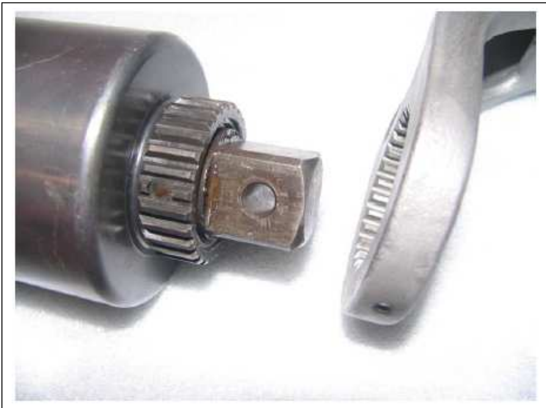
Figura 3. Instalando um Braço de Reação
