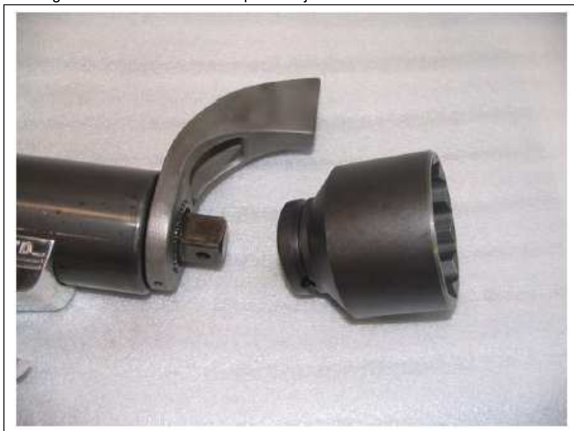
Figura 6. Instalando o soquete da jGun
