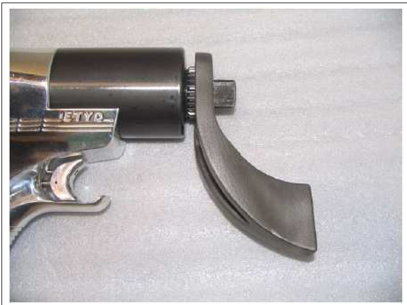
Figura 4. Braço de Reação Instalado
