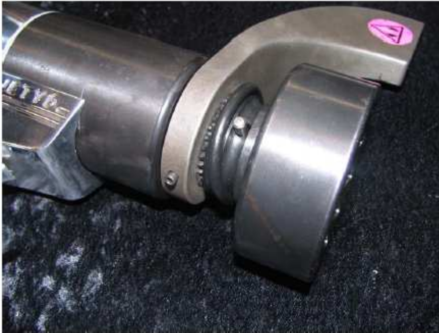
Figura 7. Instalando o Pino de Travamento e o Anel de Retenção
